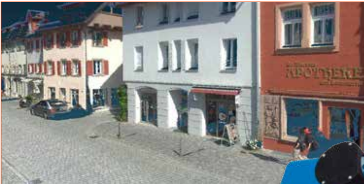
Der neue Z+F PROFILER 9020C erzeugt aufgrund integrierter Kameras auch farbige Punktwolken.
