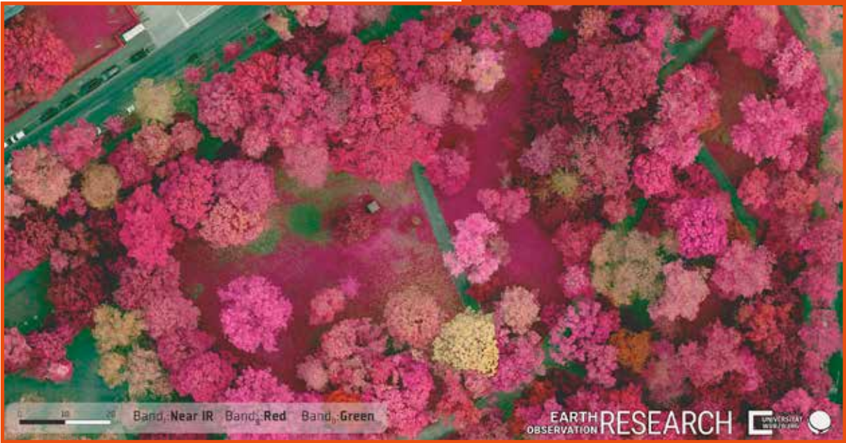
Multispektralaufnahme des Ringparks am Sanderring. Aus den Daten lassen sich zum Beispiel die Vitalität oder Wasserstress bei einzelnen Bäumen ableiten.
